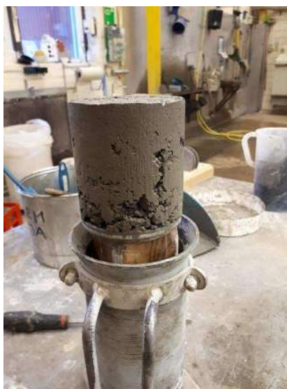
Figur 10b Ett prov med sämre kompakterbarhet i ICT
