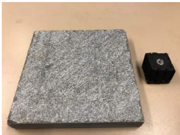
Figur 2. Till vänster vägmateriälsprovskropp och däckprovskropp. Till höger geometri för dubb, glidriktning är mot den breda diagonalen.
