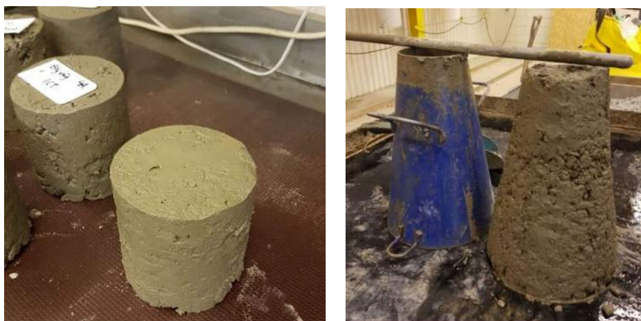
Figur 3a och 3b packad cylinder från ICT och sättmått för Torphyttan
