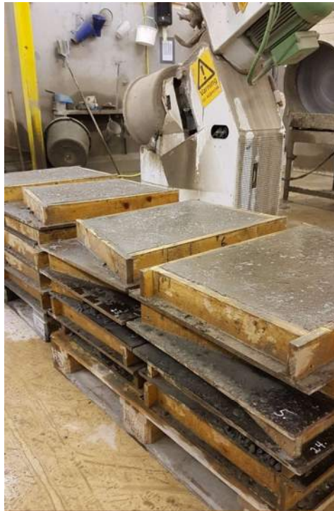
Figur 13 Tillverkning av betongplattor på Cementa Researchs lab i Slite
