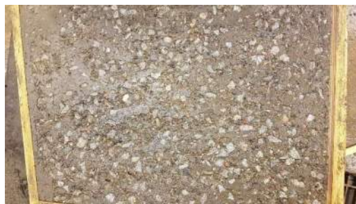
Figur 14 Samtliga plattor behandlades med ytretarder så att cementskiv tvättades bort och sten kunde friläggas.
