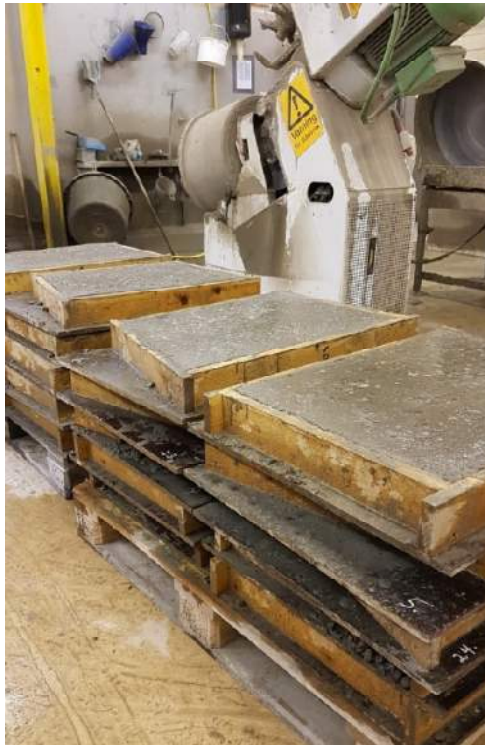
Figur 13 Tillverkning av betongplattor på Cementa Researchs lab i Slite
