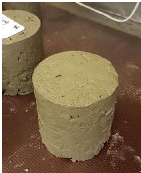
Figur 10a Ett prov med god kompakterbarhet i ICT
