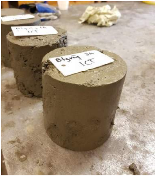
Figurer 4a och 4b Packad cylinder och sättmått för Skutskär
