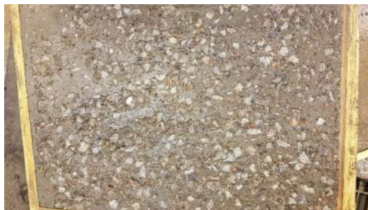
Figur 14 Samtliga plattor behandlades med ytretarder så att cementskud tvättades bort och sten kunde friläggas.
