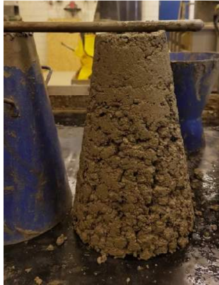
Figurer 4a och 4b Packad cylinder och sättmått för Skutskär
