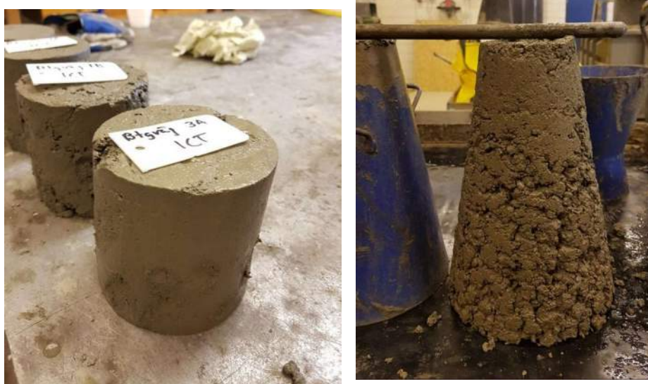
Figurer 4a och 4b Packad cylinder och sättmått för Skutskär
